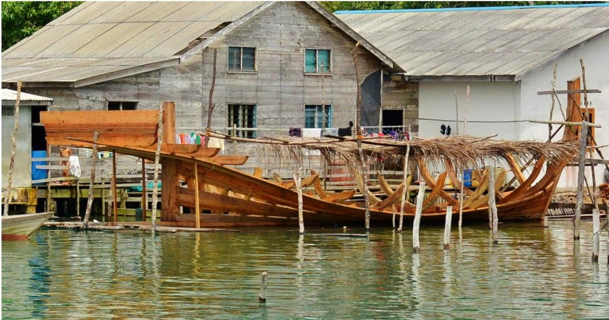
größere Maschinen, soviel wir wissen entstehen diese Boote sogar noch ohne Schrauben und Nägel; Planken, Spanten, Decksbretter werden verfugt und durch Keile und Zapfen verbunden. Die Familie lebt direkt nebenan, im gesamten Ortsbereich sind Gewerbe und Wohnungen eng verbunden. Drei Orte dieser Art passieren wir bevor unserer Kurs wieder
